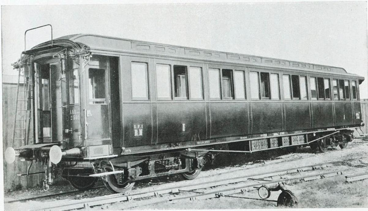
Vettura di 1<sup>a</sup> Classe a corridoio laterale (Tipo intercomunicante).
